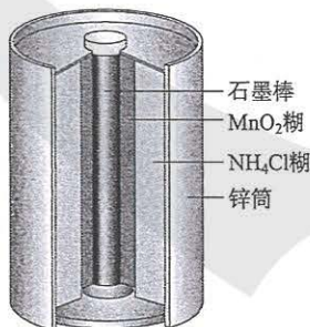
普通锌锰电池构造示意图
