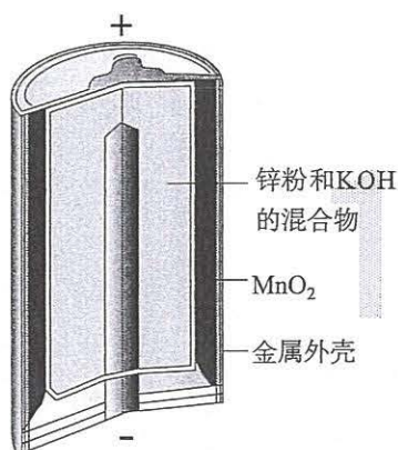
图4-3 碱性锌锰电池的构造示意图
